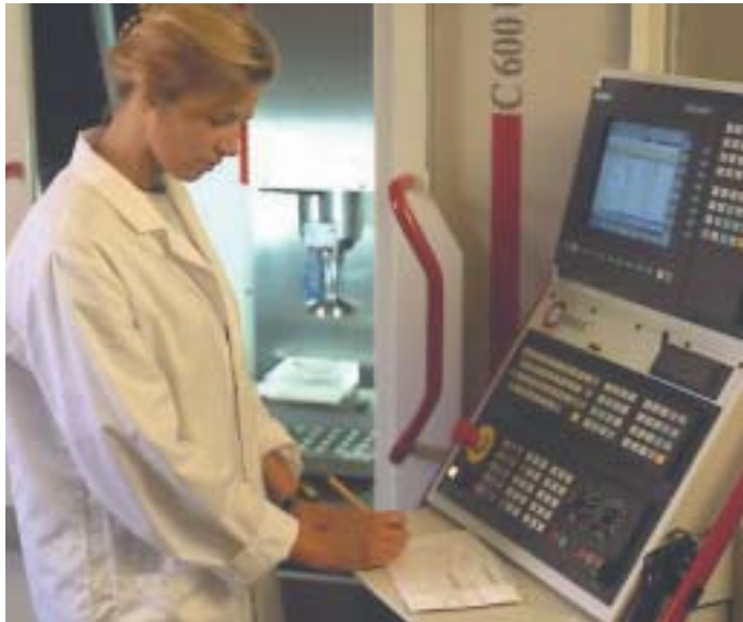
Fertigung von optischen Komponenten und Systemen Bearbeitungszentrum für optische Gläser (Foto: LINOS AG)
