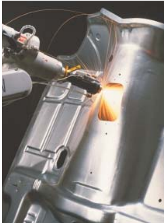
Makro- und Mikro-Fertigung mit Licht Robotergeführtes Schneiden eines 3D- Werkstückes mit einem Nd:YAG-Laser. (Foto: Rofin-Sinar)
